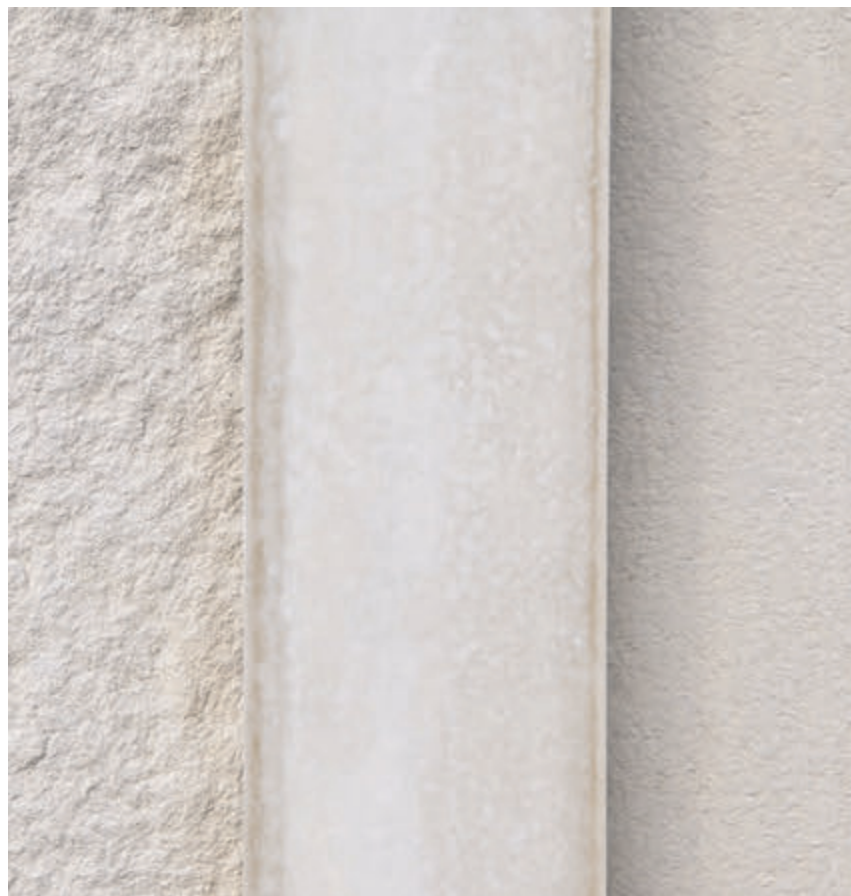
Für das Erdgeschoss stehen drei mögliche Fassadenvarianten aus Polyesterbeton zur Diskussion: Eine mit glatter Oberfläche (Mitte) sowie zwei mit unterschiedlich groben Oberflächenstrukturen.
